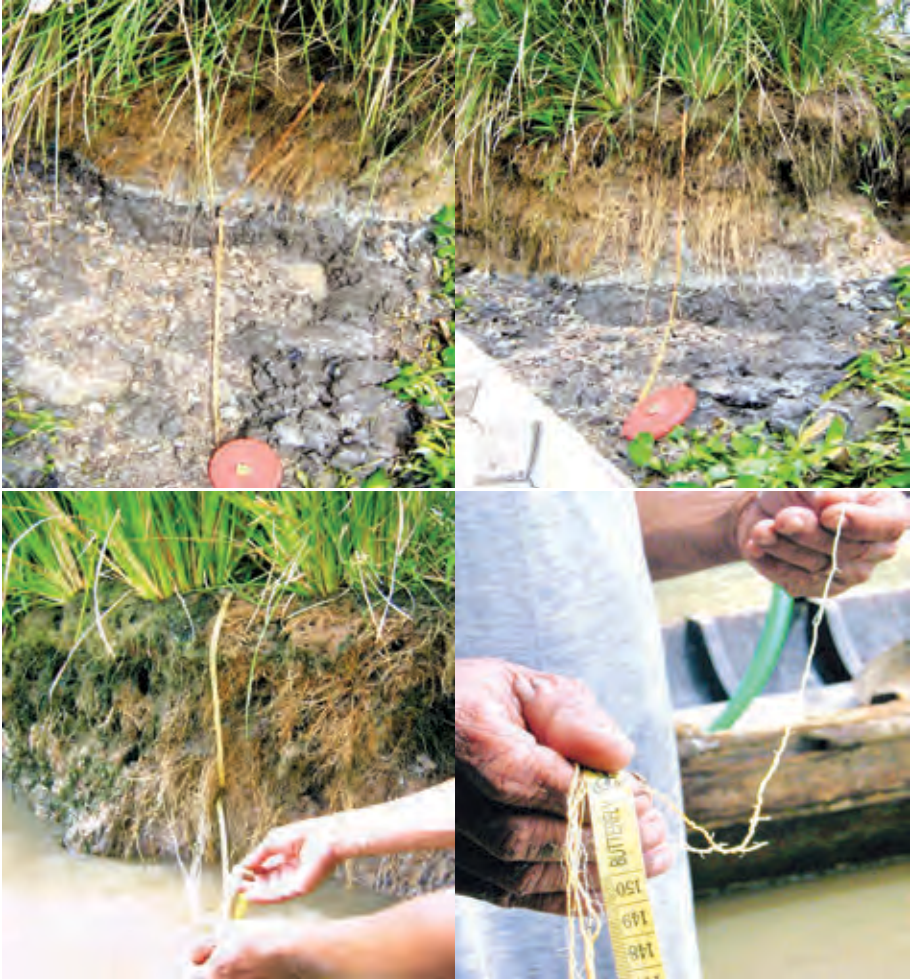
Hình 6.6: Các thí nghiệm lấy phẫu diện đất đo chiều sâu rễ cỏ (Nguyễn Văn Đồng., 2007)
