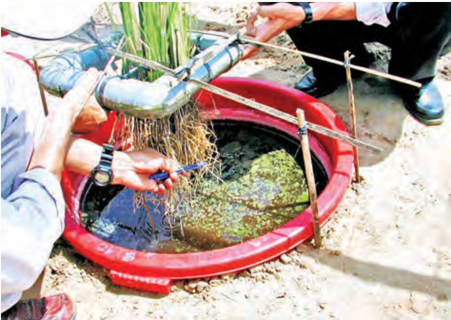
Hình 6.31: Mô hình thí nghiệm ứng dụng cỏ Vetiver xử lý nước thải từ chăn nuôi heo tại Tiền Giang 2003
