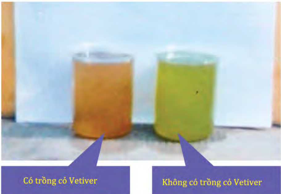
Hình 4.14: Nước thải của nghiệm thức trồng cỏ và nghiệm thức đối chứng (sau khi thí nghiệm kết thúc. Trái: Có trồng cỏ Vetiver và phải: Không có trồng cỏ Vetiver)
