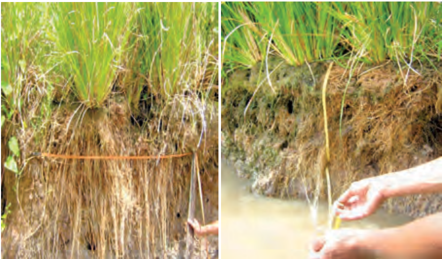
Hình 2.1: Phẫu diện đo chiều rộng và chiều dài của rễ cỏ Vetiver
